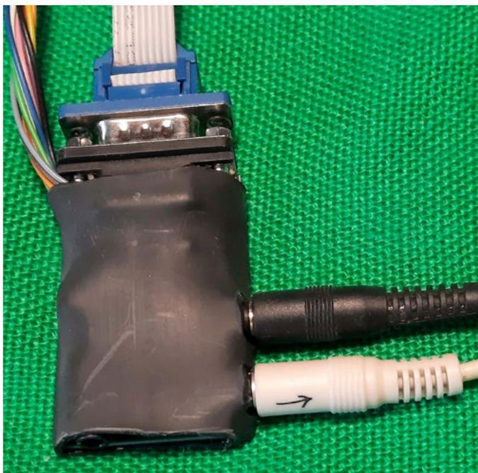
Fig.2 - L'interface terminée et protégée par la gaine thermorétractable
