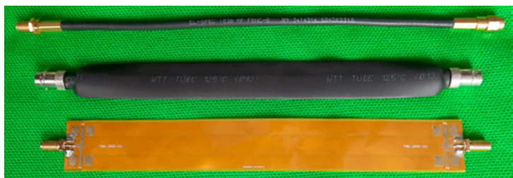
Fig.1 Les trois circuits testés : Flex, Câble 1,9 mm et câble SR 5 mm
