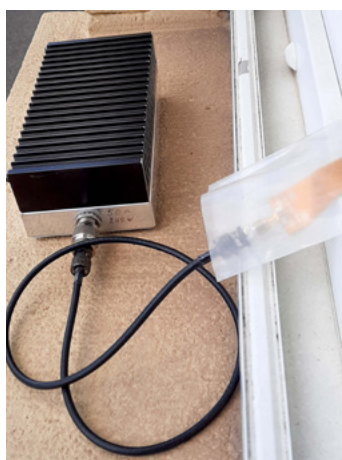
Fig.8 Côté extérieur du passage d'une fenêtre avec le Flex
