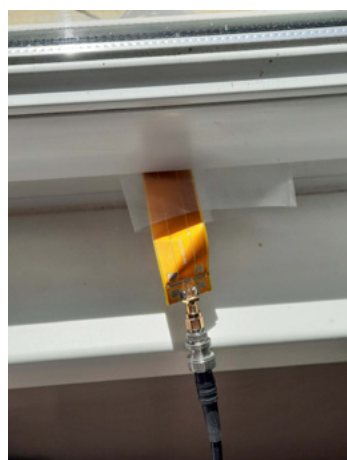
Fig.7 Côté intérieur du passage d'une fenêtre avec le Flex
