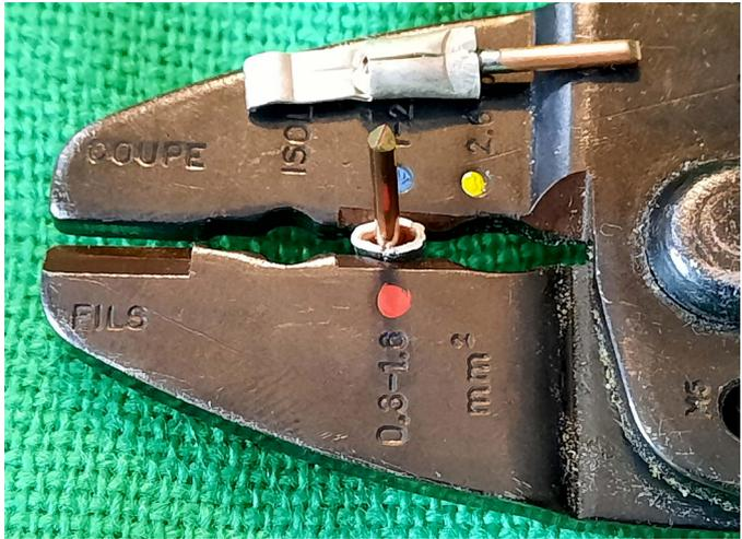
Fig.4 - Détails pour le montage des contacts des PowerPole
