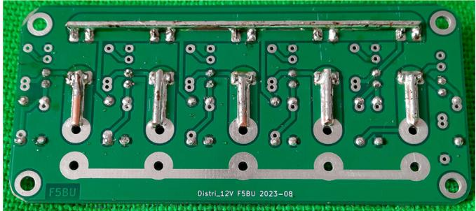
Fig.3 - Vue de dessous du circuit imprimé en cours de câblage. Les PowerPole et le fil de cuivre sur la piste de masse ne sont pas encore montés
